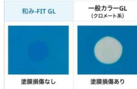
耐酸性雨性 5%硫酸滴下→60℃・30分放置→水洗
